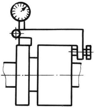
Рисунок 2-Приспособление для центровки
