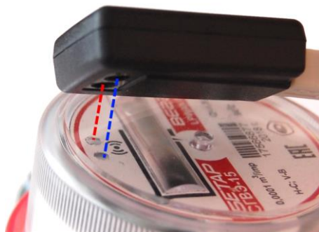
Р и с у н о к 8 — Расположение адаптера «Оптопорт-USB» относительно счетчика_Крупный план
